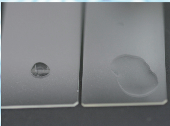
左：未処理 右：紫外線／オゾン処理 スライドガラスに水を滴下
