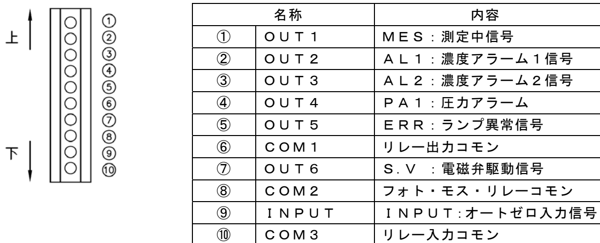
図-12 比較入出力ユニットの端子図
