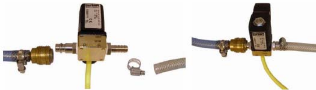
図 6-4: 洗浄用バルブへの顧客調達圧縮空気用ホースの接続
