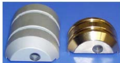
図9-5: 100 mm から 35 mm (左)と 35 mm から 5 mm ( )への光路長短縮用挿入具
