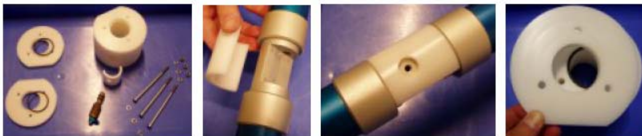
図 6-15: バイパス装具内へのプローブの設置準備
