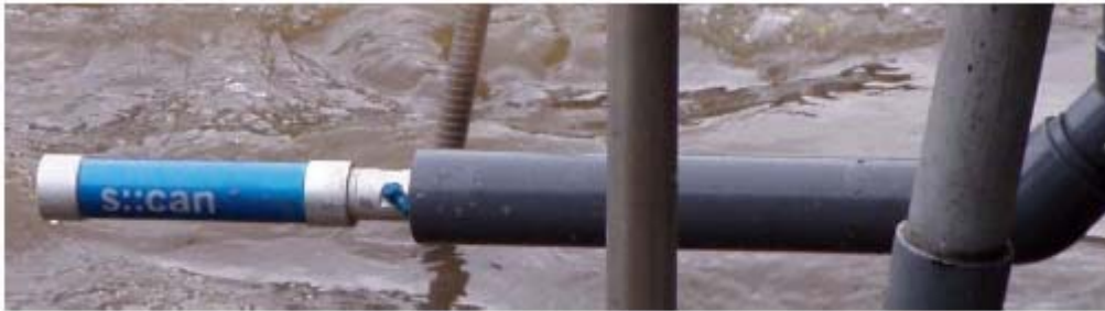
図 6-1: 分光計プローブの正しい取り付け方向
