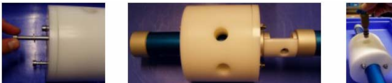
図 6-16: プローブと圧縮空気洗浄器具の設置
