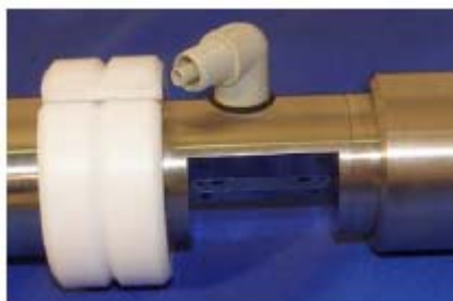
図 6-8: 圧縮空気用継手の取り付け
