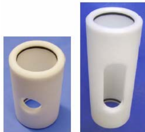
図 9-4: 35 mm 迄(左)と 100 mm ( )の分光計プローブ用多機能のスライド
