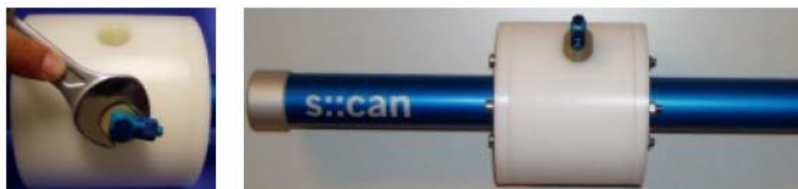
図 6-17: 圧縮空気洗浄継手の設置
