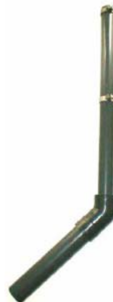
図 9-6: 延長管を装着したプローブ取付台
