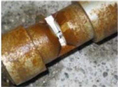
図 8-1: 測定窓の圧縮空気水圧洗浄の効果
